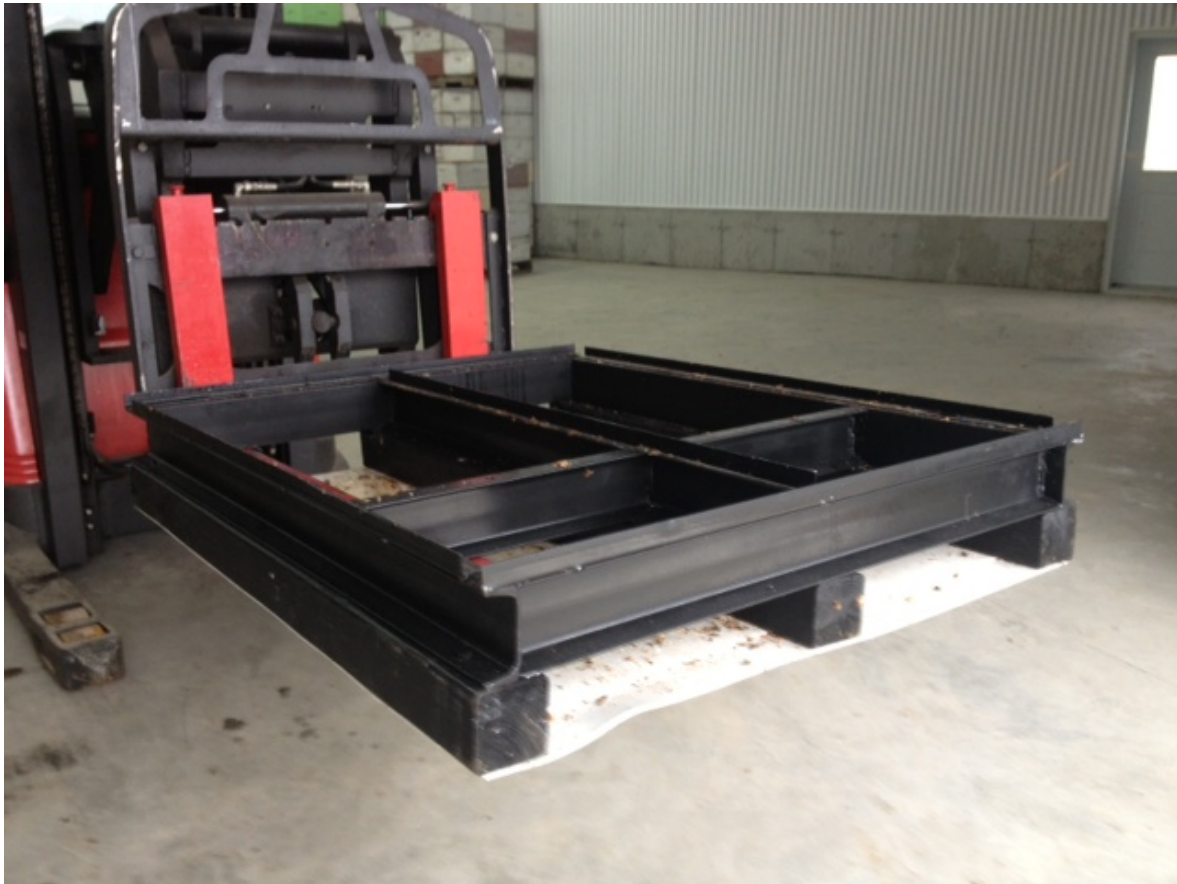
Figure 2 : Palette spécialement adaptée de 48 pouces sur 40 pouces. Un espacement de 4 pouces au fond permet l'aspiration de l'air chaud et sec qui a été introduit par le haut des hausses. Le fond de la palette est muni d'une feuille de PVC afin de prévenir les gouttes de miel au sol.
